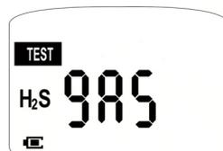
**Figura 4-2: Teste de resposta manual - Aplique o gás**
