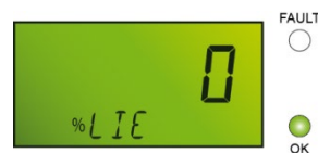
Figure 23: affichage en fonctionnement normal
