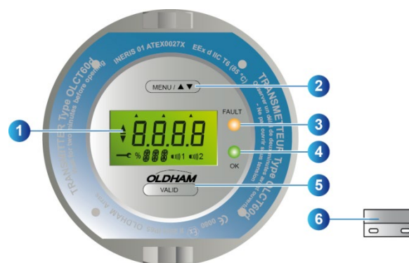
Figure 3: détail de l'afficheur et de ses périphériques (voyants, zones actives)
