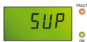
Figure 25: affichage après détection d'une haute teneur en explosimétrie
