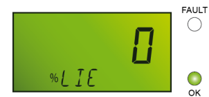
Abbildung 23: Anzeige im Normalbetrieb
