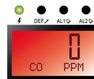
Imagen 9: pantalla bajo condiciones de funcionamiento normales. La luz indicadora verde de ⚡ parpadea.
