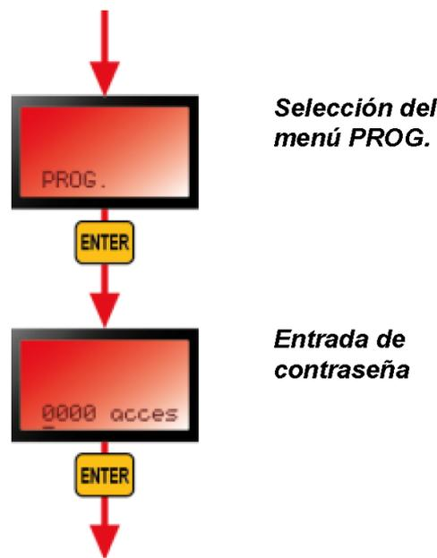
Imagen 19: se requiere contraseña (contraseña por defecto: "1000") para acceder a los submenús *PROG.*
