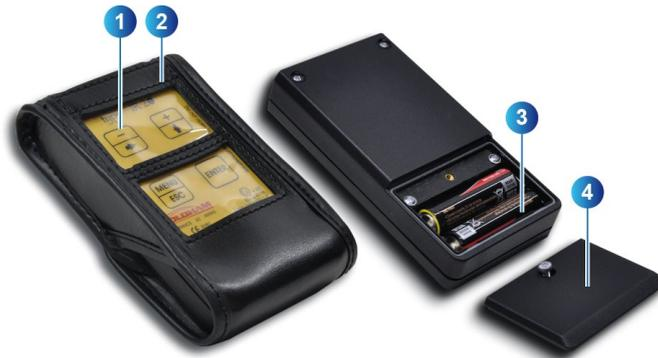
Imagen 64: instalación de nuevas baterías AA (1,5 V).
