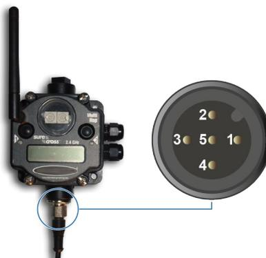
Imagen 46: conectar el conector de 5 pines del *receptor principal*.
