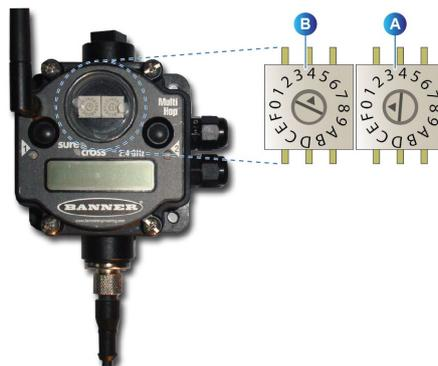
Imagen 51: configurar la dirección del receptor principal en @50.
