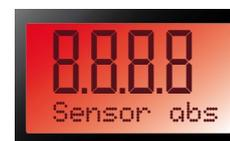
Imagen 10: en el caso de una alarma o fallo, se muestra el tipo de fallo. La luz indicadora naranja de DEF/ permanece encendida como una luz sólida.
