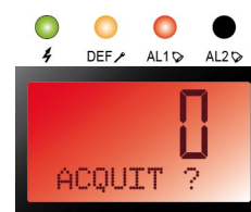
Рис. 57. Квитирование аварийного сигнала осуществляется нажатием ENTER в режиме отображения показаний.
