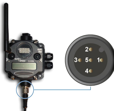
Рис. 46. Назначение выводов 5-контактного разъема Мастер-приемника.
