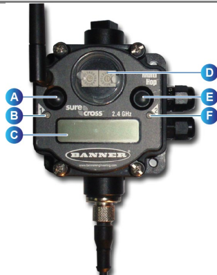
Рис. 52. Расположение кнопок и индикаторов на Мастер-приемнике.
