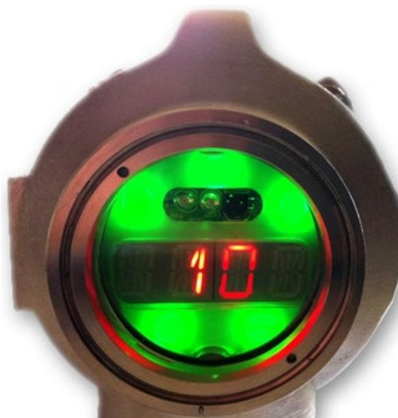
A orientação permite uma comunicação com  $\frac{1}{2}$  ângulo horizontal em torno de  $35^\circ$ , um  $\frac{1}{2}$  ângulo vertical para cima em torno de  $30^\circ$  e um ângulo vertical para baixo em torno de  $50^\circ$ .
