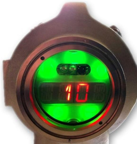
A orientação permite uma comunicação com  $\frac{1}{2}$  ângulo horizontal de cerca de  $35^\circ$ ,  $\frac{1}{2}$  ângulo vertical para cima de cerca de  $30^\circ$  e um ângulo vertical para baixo de cerca de  $50^\circ$
