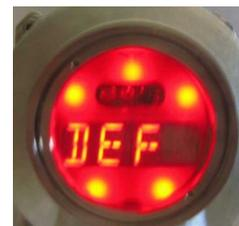
O dispositivo entra em modo de aquecimento (consulte 6.3) por 90 segundos. O detector está em modo de inibição. A saída de corrente e o relé padrão (se estiver na configuração de fábrica) são consequentemente ativados.
