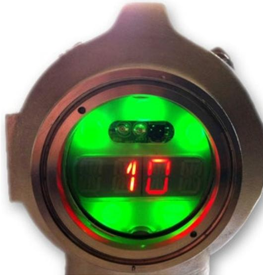
La disposition permet une communication avec un ½ angle horizontal d’environ 35°, d’un ½ angle vertical haut d’environ 30° et d’un angle vertical bas de l’ordre de 50°.
