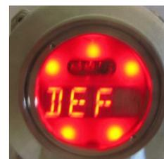
L'appareil passe alors dans l'état de préchauffage (se reporter aux paragraphes 6.3 en ce qui concerne l'état des sorties) pour une durée de 90 sec, l'appareil est en mode inhibition, la sortie courant et le relais de défaut (si configuration usine) sont activés en conséquence.
