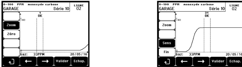
Figure 21 : Réglage du zéro (gauche) et de la sensibilité (droite).
