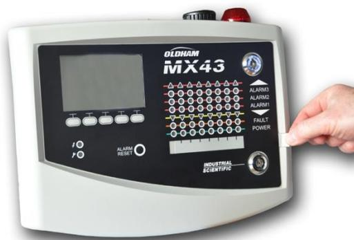
Abbildung 13: Herausziehen des Beschriftungsstreifens
