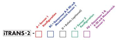
Beispiel: iTrans 2 - 1C21241 iTrans2 mit lokalem UEG Sensor (4-20 mA - Messbereich 0-100% UEG) und einem abgesetztem H2S Sensor (4-20 mA - Messbereich 0-500 ppm) inklusive integrierten Relais und Modbus RTU.
