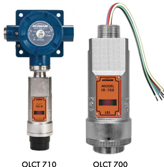
Los dispositivos electrónicos, supervisados por microprocesador, están dentro de un módulo encapsulado y ubicados en un cuerpo de fundición a pruebas de explosiones. La unidad incluye un LED de 4 caracteres alfanuméricos utilizados para mostrar las lecturas del detector y la interfaz del detector, manejada a través de un menú, cuando se usa el imán de programación manual.
