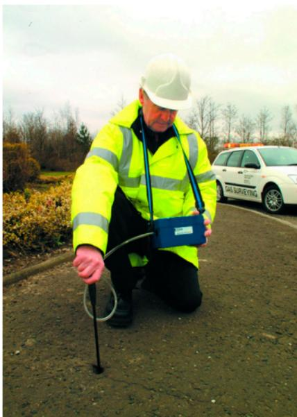
*Fig. C-1 Solid End Probe*
