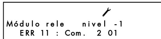
**Falla de comunicación** de Módulo 1 de la línea 2. Verificar la línea y/o el módulo. La falla desaparecerá con la desaparición del problema.
