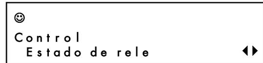
Después de validación por la tecla [OK], se indica el estado del rele seleccionado. Esta pantalla recuerda el módulo, la función de este módulo (Normal, Buzzer, PV, GV, ...) y son estados( ON, OFF).
