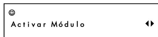
La alimentación de la línea es protegida contra el cortocircuito por un fusible térmico. En ese caso, una palabra defecto aparecerá en este menú y un mensaje de error figurará en los acontecimientos. Después de la desaparición del cortocircuito, es necesario activar de nuevo la línea por este menú.
