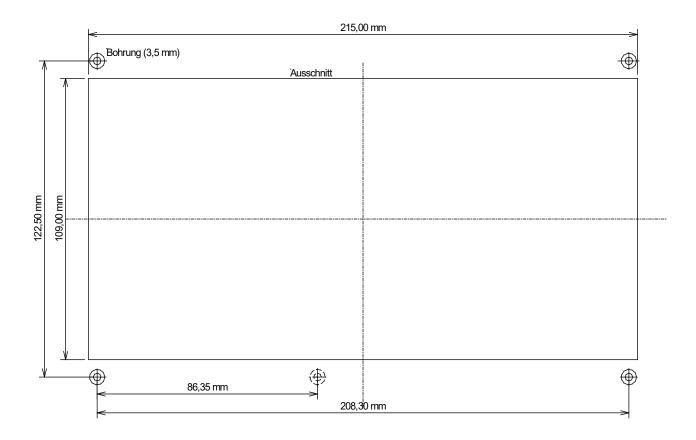
Die Frontplatten haben eine Gesamtgröße von 243 x 149 mm. Oben und unten überragen die Frontplatten den Ausschnitt um 20 mm, links und rechts überragen die Frontplatten den Ausschnitt um 14 mm.
