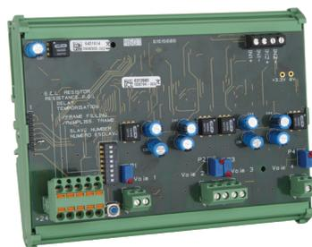
Modulo indirizzabile a 4 uscite analogiche che fornisce quattro uscite analogiche di segnale 4-20mA (copia dell'uscita del rilevatore, min, max, media di un gruppo di rilevatori) per il collegamento a un datalogger, un PLC, un sistema di gestione degli edifici (BMS), ecc.
