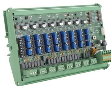
Può collegare trasmettitori analogici standard (ad esempio, rilevatori di gas o di fiamma) su una linea digitale per risparmiare sui costi.
