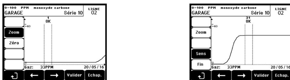
Figure 39 : Réglage du zéro (gauche) et de la sensibilité (droite).
