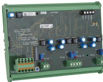
Modul adresabil cu 4 ieșiri analogice 4-20 mA (copiere semnal de ieșire detector, min, max, media unui grup de detectoare) pentru conectarea la un datalogger, un PLC, un sistem de gestiune clădiri (BMS) etc. Fiecare modul dispune de asemenea de 2 intrari logice.
