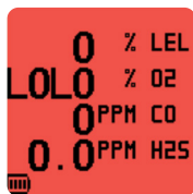
Exibição a vermelho em condições de alarme
