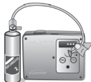
Alors que l'air zéro balaie la cellule de détection, maintenez enfoncé le bouton
