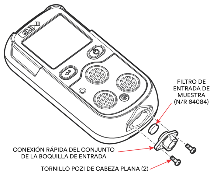
Figura 8-2: Sustitución del filtro de entrada de muestra (polvo)
