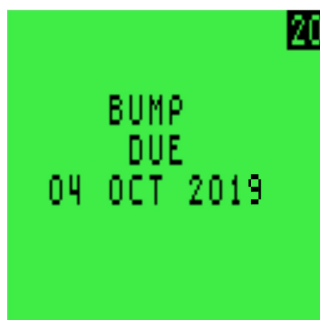
Figura 3-7: Fecha de vencimiento de la prueba funcional
