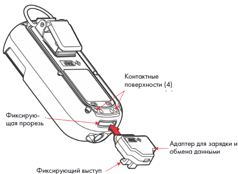
Рисунок 7-1: Подключения адаптера для зарядки и обмена данными
