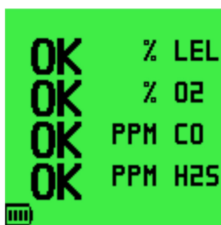
Рисунок 2-4: Вид дисплея в режиме отображения «ОК» (4-канальный режим)
