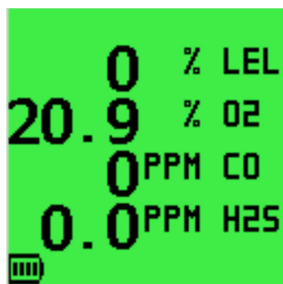
Рисунок 3-13: Стандартный рабочий экран четырехканального газоанализатора
