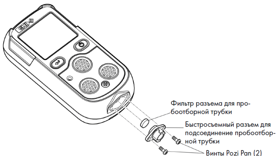
Рисунок 8-2: Замена противопылевого фильтра на входе пробоотборной линии
