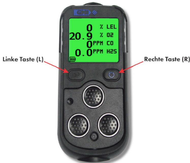
Abbildung 3-1: Funktionstasten
