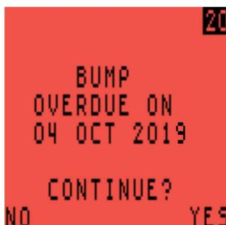
**Abbildung 3-8: Fälligkeitstest überfällig**
