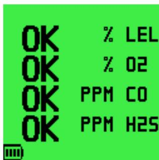
**Abbildung 2-4: Beispiel eines OK-Displays (4-Gas)**
