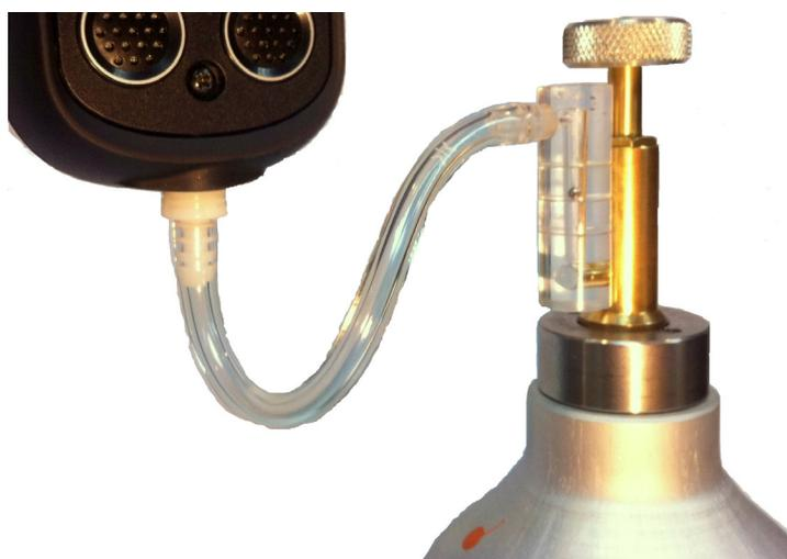
**Figure 6-4: Kit de test fonctionnel**
