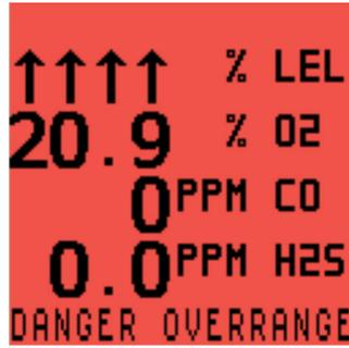
Figure 4-3 : Alarme hors plage haute
