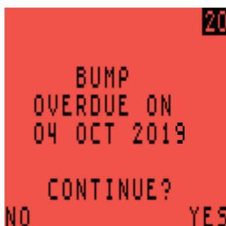
**Figure 3-8 : Bump Overdue (Date du test fonctionnel dépassée)**
