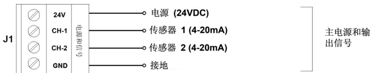
圖A - 6支持HART 的iTrans 2上的電源和信號連接器J1
