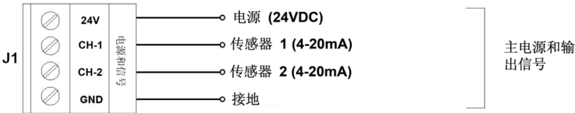
图 A - 6 支持 HART 的 iTrans 2 上的电源和信号连接器 J1
