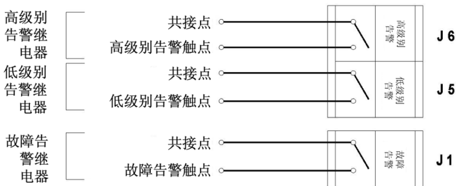
图 4-1 报警继电器连接器 J6、J5 和 J1
