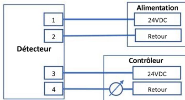
Figure 15 : Schéma source à 4 fils
