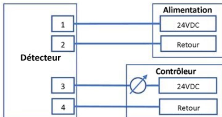
Figure 16 : Schéma sink à 4 fils
