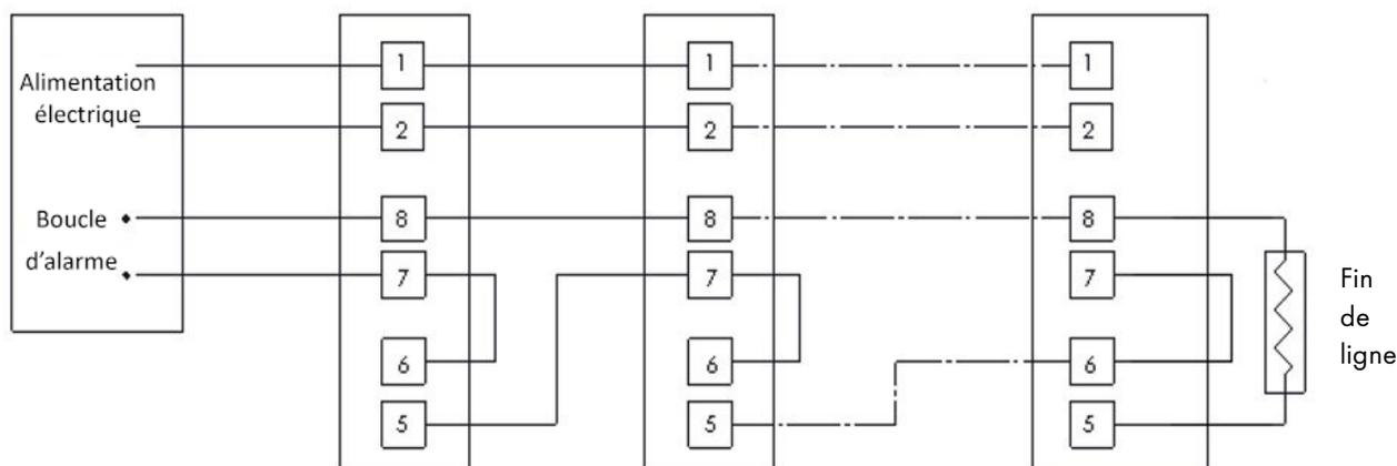
Figure 19 : Connexion relais 4 fils
