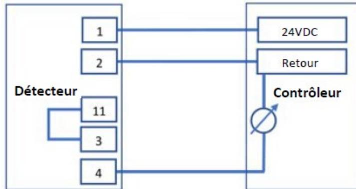
Figure 17 : Schéma source à 3 fils
