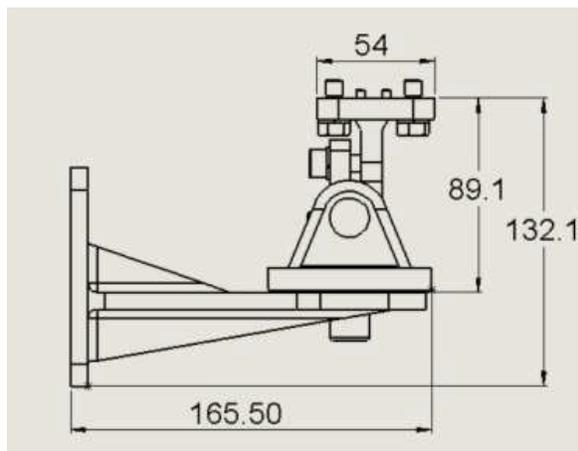
Figure 12 : Rotule de fixation – Vue latérale
