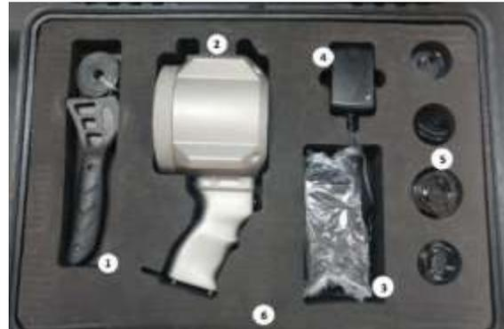
Figure 7 : Kit de simulateur de flamme
