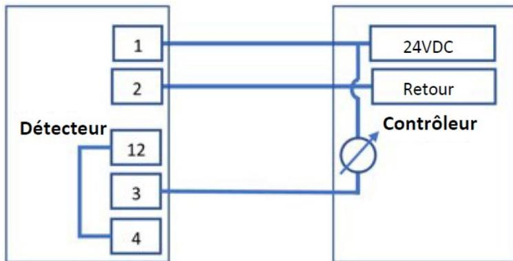
Figure 18 : Schéma sink à 3 fils
