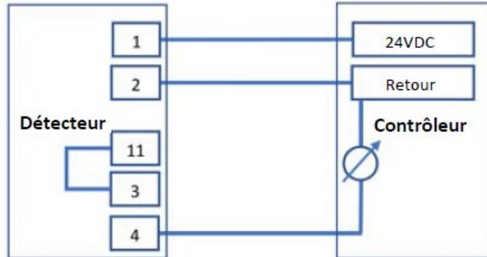
Figure 19 : Schéma source à 3 fils
