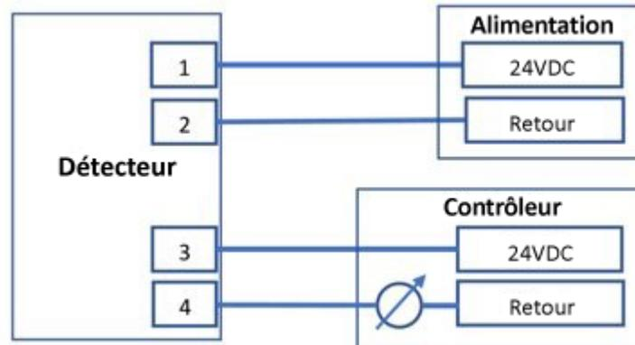
Figure 17 : Schéma source à 4 fils
