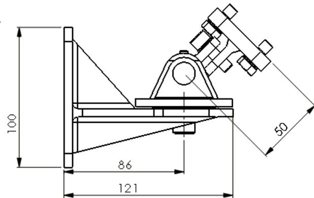
Figure 14 : Rotule de fixation – Vue latérale
