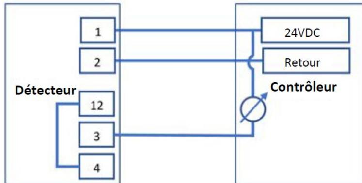
Figure 20 : Schéma sink à 3 fils
