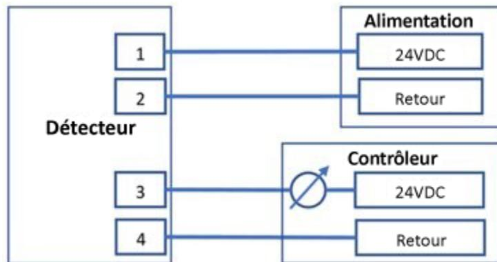
Figure 18 : Schéma sink à 4 fils
