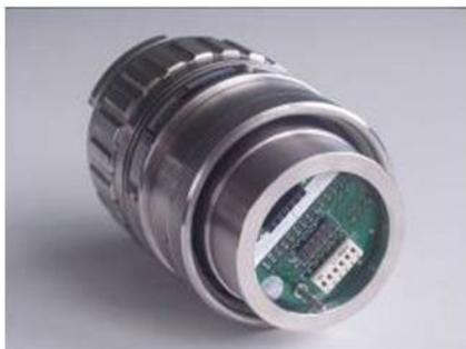
Die Einheit ist vom Detektor getrennt, damit sie ausgetauscht werden kann. Der Ausbau ist sehr einfach und erfordert keine Eingriffe in das übrige Gerät.
