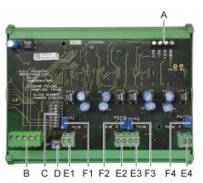
Figure 26: 4-analog output module.
