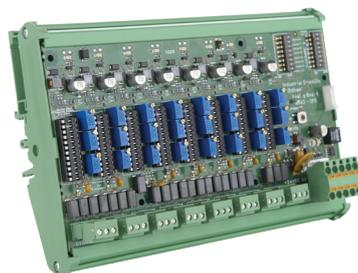
可在一条数字线路上对标准模拟变送器（例如气体或火焰检测仪）进行连接以节约成本。
