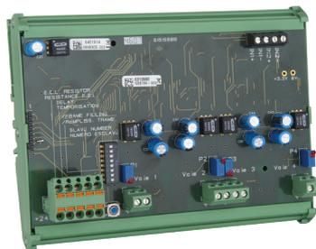
可寻址4个模拟输出模块，可提供4种模拟4-20 mA 信号输出（一组检测仪的检测输出拷贝、最小值、最大值、平均值）以连接至数据记录仪、PLC、楼宇管理系统（BMS）等。
